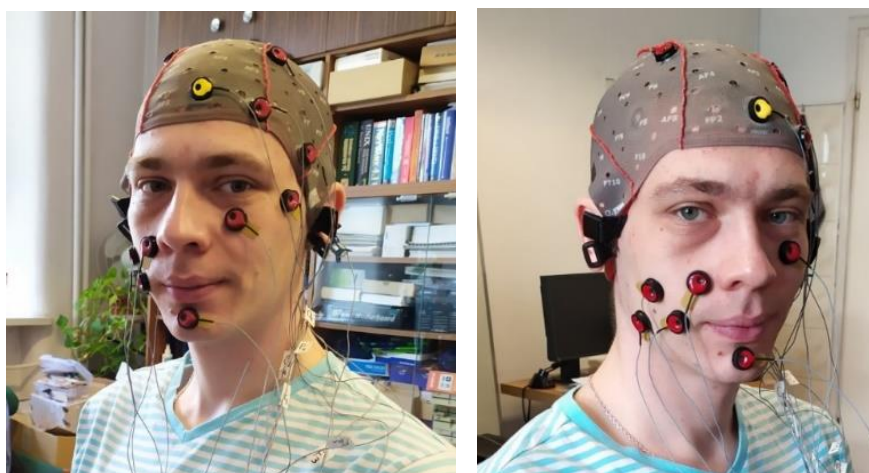
Rysunek 2. Przedstawienie rozkładu elektrod podczas tworzenia bazy artefaktów.
